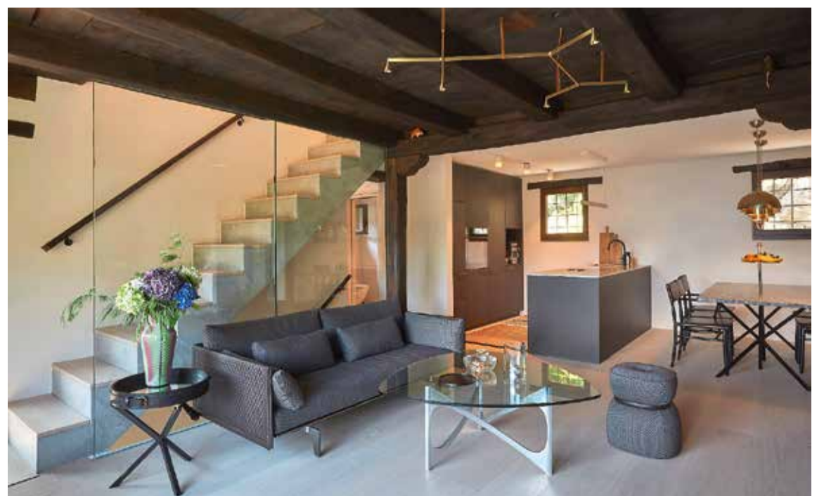
Das Wohnzimmer: Sichtbalken aus dunklem Kastanienholz kontrastieren mit dem hellen Mineralverputz und den weiss geölten Parkettböden. Die Treppe aus Sichtbeton führt in die beiden oberen Geschosse.
